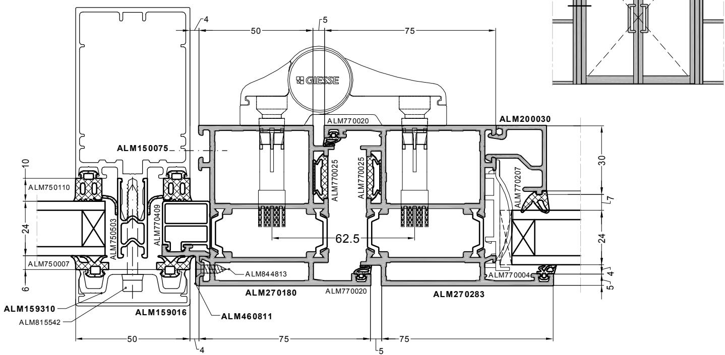
6.16.Дверь наружного открывания , встроенная в фасад
