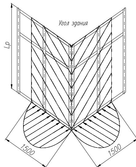
Во всех трех случаях принятая схема закрепления стойки как шарнирно-опертой однопролетной балки. Расчет вертикальной стойки на деформацию в зависимости от ветровой нагрузки проводится по условию жесткости (1-й расчетный случай) и применяется для всех стоек.
