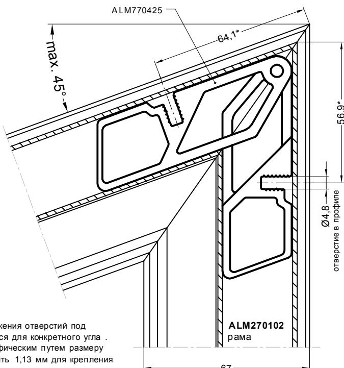
\*Размеры расположения отверстий под штифт определяются для конкретного угла . К полученному графическим путем размеру необходимо добавить 1,13 мм для крепления "внатяг".
