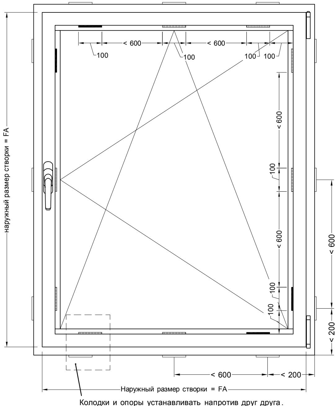
█ Колодки под раму по периметру строительного проема
